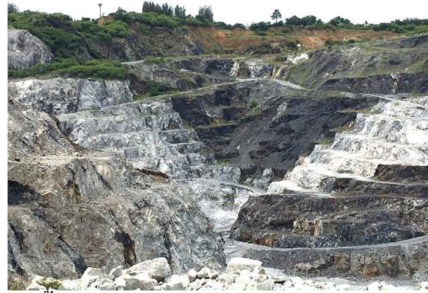
รูปที่ 2-1: การทำเหมืองแบบขั้นบันได
